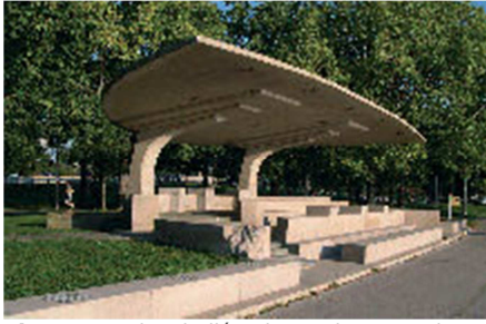
Figura 8. El pabellón de ajedrez en el Lincoln Park de Chicago fue diseñado por el arquitecto Morris Webster y construido en 1956. El pabellón es un elemento distintivo del paisaje, con su losa de hormigón armado en voladizo que proporciona cobertura para los jugadores de ajedrez.
